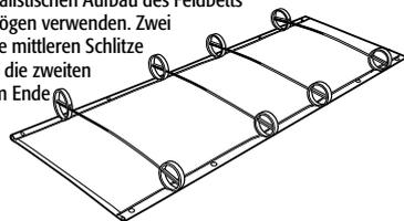
**Tipp:** Indem Sie die Einzel- oder Drehbögen in unterschiedliche Schlitz einsetzen, können Sie die Stützkraft wunschgemäß anpassen.
