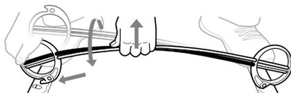
Den anderen Standfuß um 180° (um die eigene Achse) drehen, bis der Haken zum Bezug zeigt. Die Bogenmitte mit einer Hand vom Bezug wegziehen und gleichzeitig mit der anderen Hand nach unten drücken, um den zweiten Standfuß einzuheken.
