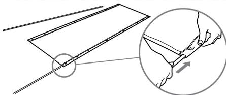
Stoffbezug mit der *Unterseite* nach oben auf den Boden legen. Stangen mit Gestängegummi zusammensetzen und in die Hülsen einführen.
